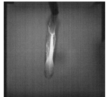
„Wassertropfen auf eine ITO-Beschichtung – Aufgenommen mit einer Wärmebildkamera“
