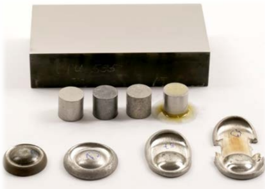
Abbildung 1: Proben und Werkzeug des Tribometers Gleitstauchversuch
