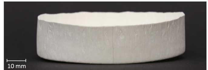
Abbildung 2: Mittels hydromechanischem Tiefziehen hergestellter Napf aus Papier unter Dampfeinbringung im Niederhalterbereich
