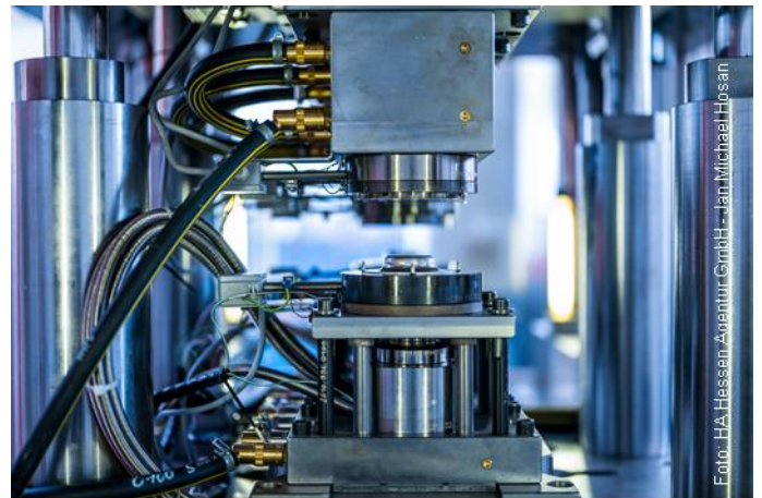
Abbildung 2: Seitenansicht des vierstufigen Umformwerkzeugs inkl. der Kühl-, Heiz- und Thermoelementanschlüsse
