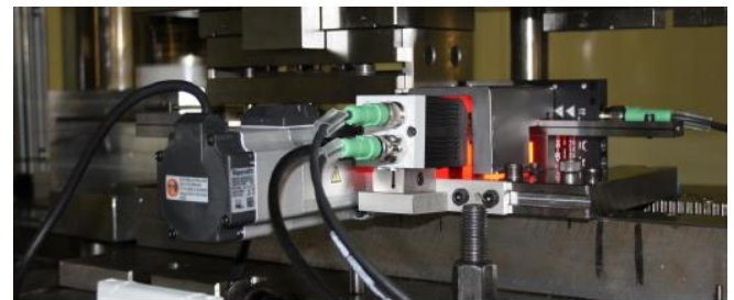
Abbildung 2: Prozesskette Stanz-Biegen mit integrierter Sensorik (Kamera rechts) und Aktorik (Stellantrieb links)
