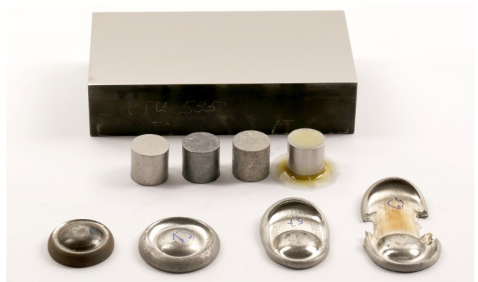
[1] Proben und Werkzeug des Tribometers Gleitstauchversuch
