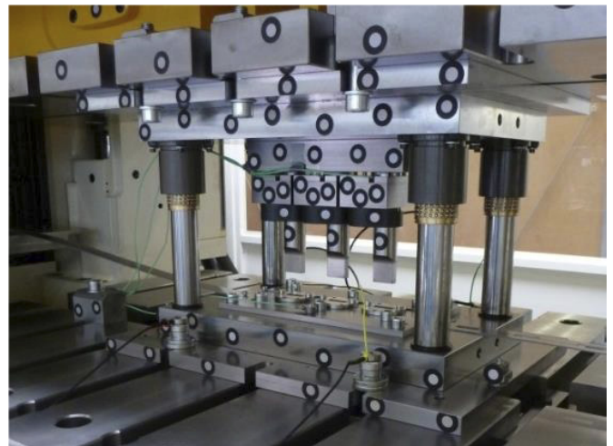
[1] Werkzeug mit Referenzpunkten für optische Schwingungsmessung
