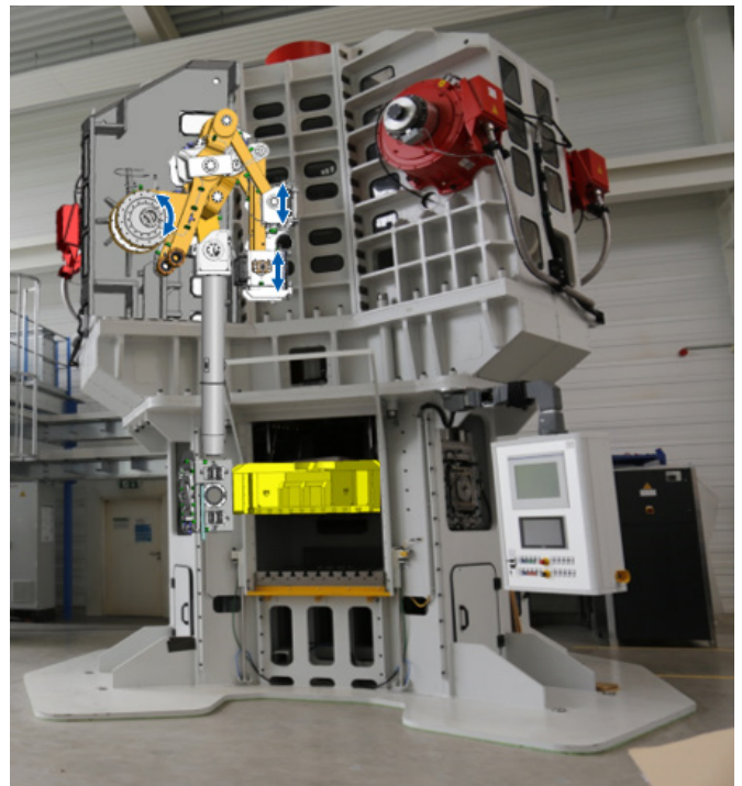
[1] 160t-Version der 3D-Servo-Presse mit schematischer Darstellung des Getriebes
