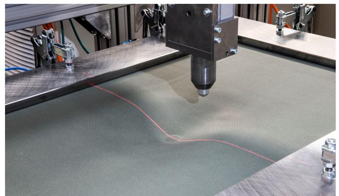
[2] 3-Achs-Portalanlage mit Vulkanfiberkegel während der Geometriebestimmung mittels Linienlaser
