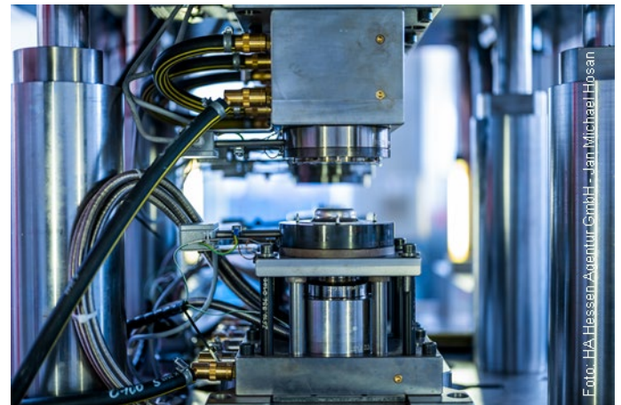
Abbildung 2: Seitenansicht des vierstufigen Umformwerkzeugs inkl. der Kühl-, Heiz- und Thermoelementanschlüsse
