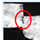
Riss in einem Schliff des Profilquerschnitts
