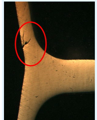
Riss in einem Schliff des Profilquerschnitts
