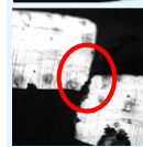
Rissbildung beim Stanzen von Blechbauteilen
