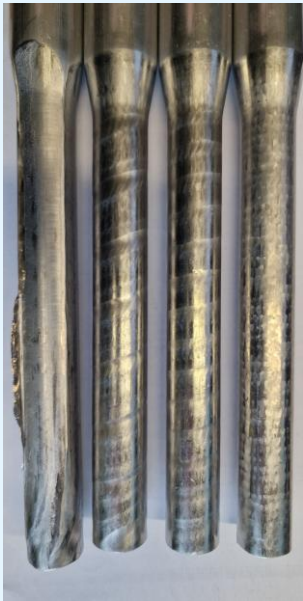
Abb.2: Einfluss des Drehvorschubwinkels auf die Spiralbildung
