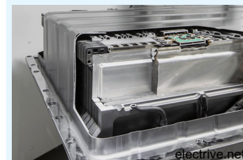
Typische KFZ-Batteriezellen mit Schutzeinhausung
