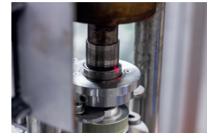
Die Fertigung der Aktoren erfolgt im Laserbearbeitungszentrum
