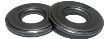
Laser-geschweißte Aktorprototypen nach erfolgreicher Fertigung
