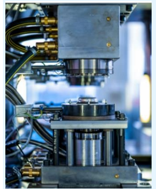
Seitenansicht eines temperierbaren Versuchswerkzeugs Side view of a temperature-controlled tool
