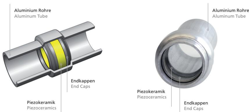
[2] Beispiel für eine metallische Struktur mit eingeformtem Funktionsmaterial
