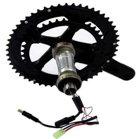
[1] Tretlager mit integrierter Sensorik zur Erfassung von Drehzahl und Drehmoment
