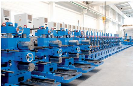
Flexible Fertigungsanlage zur Herstellung verzweigter Mehrkammerprofile
