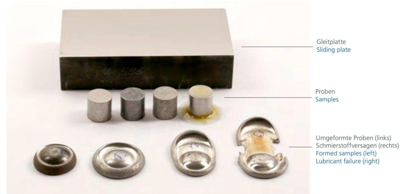
Abbildung 1: Proben und Werkzeug des Tribometers Gleitstauchversuch
