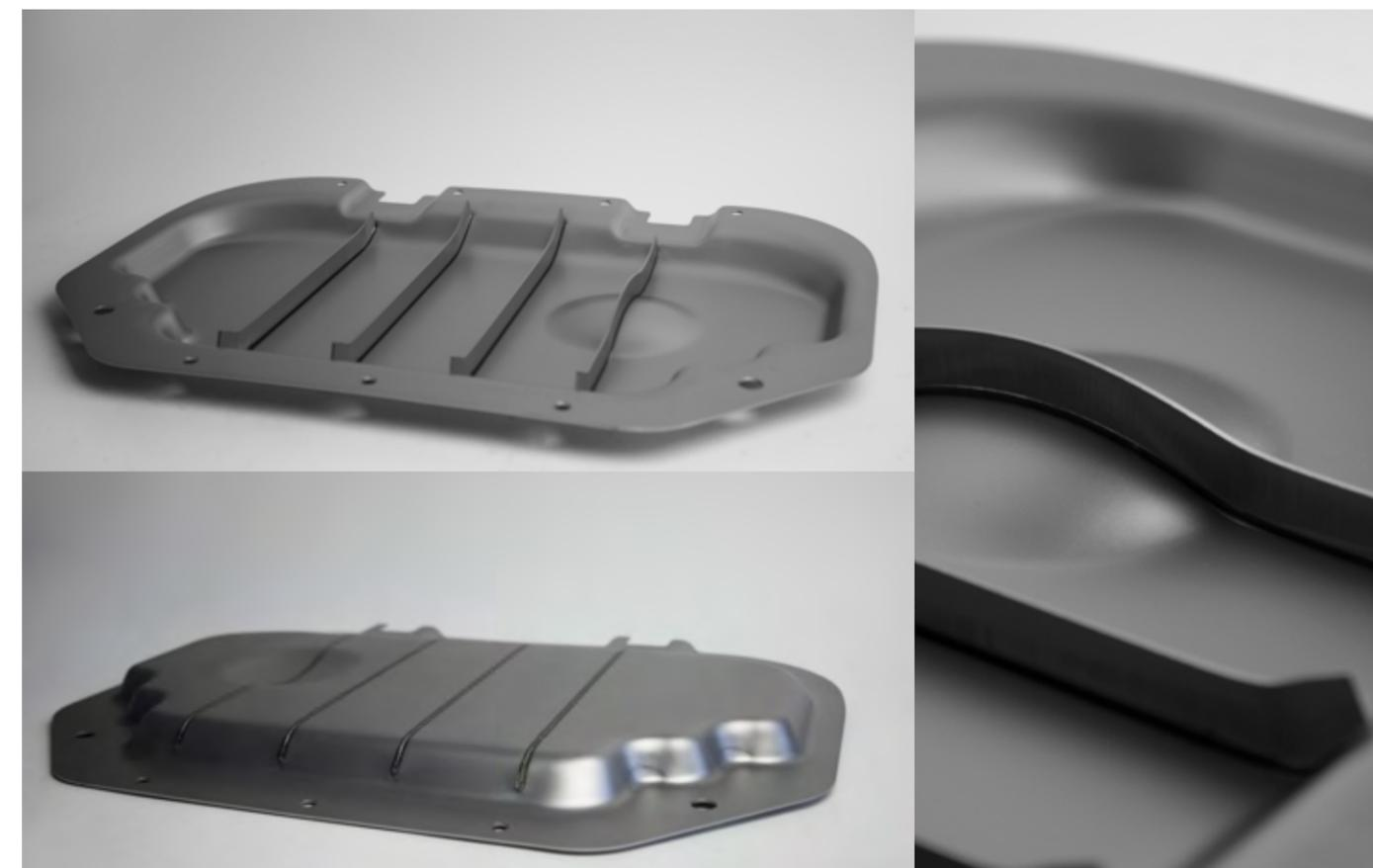
Abbildung 3-5: Abstrahierter Unterfahrschutz mit Stegversteifung
