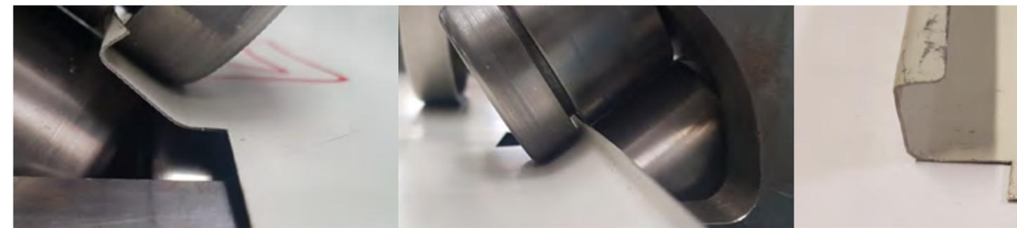
Abb. 3: Erzeugung der Fugengeometrie durch flexibles Walzprofilieren
