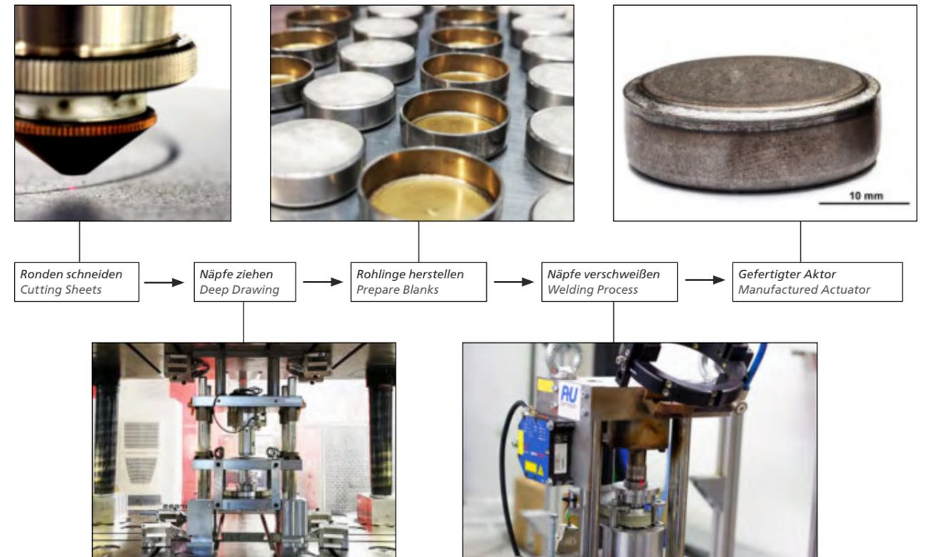
Abbildung 1: Fertigungskette der Aktor – von dem Schneiden der Platinen zum fertigen Dehnstoffaktor
